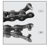
ピンの中央付近で(ホ)のように破断しますがその破断 面は小さな凸凹がある平面です。
