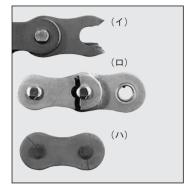
きはクラックがピッチ線(両ピン間の中心線)とほぼ直 角方向に生じることが大きな特徴です。酸による水素脆 性破壊の場合はクラックの方向は(ハ)のような場合が 多く、切り口は平面で切り口周辺は酸に侵され変色して いることもあります。
