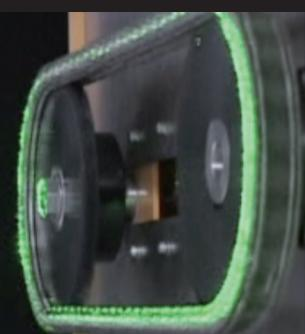
③弊社が今回ご提案するD.I.Dシールチェーンシリーズ製品です。チェーンを回転させてもほとんど塵飛散は確認できません。弊社で研究開発したシール構造が完璧に近い状態で塵飛散を防いでいます。
