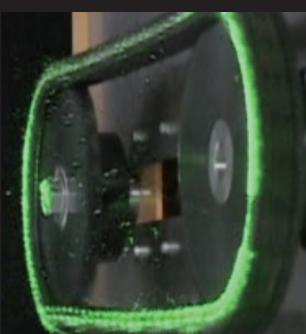
②一般的な燃結ブッシュを使用した無給油チェーンでの塵飛散状態です。一般的なローラーチェーンよりも無給油仕様なので、油飛散は少なくなります。
