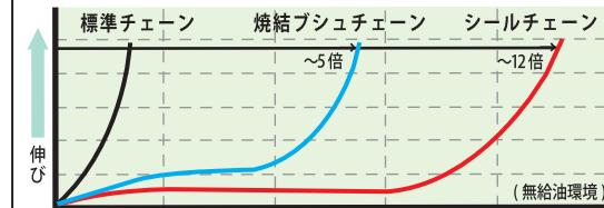
シールチェーンの構造は各チェーンの外プレートと内プレートの間にシールを入れた構造になっています。弊社で研究開発した、シールリングは、シールを押し潰さずX形状に変形したゴムが、十字形状に戻ろうとする反発力を利用して、注入されたグリースを保持し、飛散を防止します。接地面は5点になり増えますが、接地面積はOリングの約半分になるため、フリクションの低減を実現します。また、弊社オリジナルのXリングとグリースはチェーン内の摩擦により発生する塵を最小限に抑える働きも併せ持ち、クリーンルーム環境に対応できる性能を発揮します。
