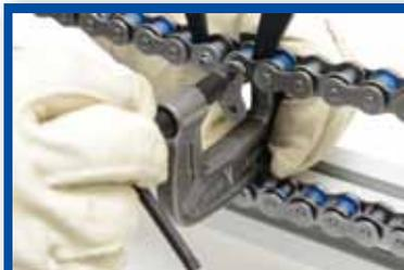
継手プレートとシールリングを外します。
