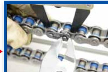
プライヤーを使用してジョイントを外します。
