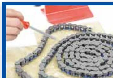
内・外プレートの順に数え装置の仕様にリンク数を合わせる。**注)1**
